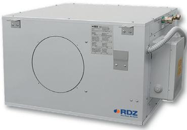
Modulo di deumidificazione isoteramico canalizzabile progettato per l'installazione orizzontale in controsoffitto da abbinare a un'unità di ventilazione meccanica controllata con adeguata portata d'aria. È costituito da unità frigorifera completa e batterie di pre e post trattamento da alimentare con acqua refrigerata (15 °C). L'unità è sprovvista di ventilatore. Prevedere obbligatoriamente un sifone su scarico condensa (SF-P).
